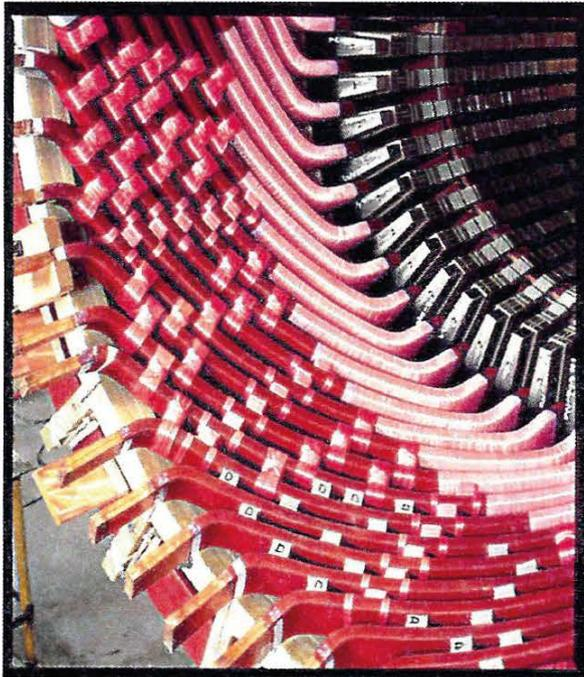
Luftgekühlte Generatoren sind je nach Anforderungsprofil mit unterschiedlichen Kühlsystemen lieferbar. Sie sind für Gas-, Gas- und Dampfturbinen(GuD)-, Kraft-Wärme-Kopplung- und Dampfkraftwerke bis zu einer Leistung von 350 MVA geeignet. Im Bild der luftgekühlte Generator des Typs SGen5-1000A im GuD-Kraftwerk Charlotte in North Carolina, USA.
